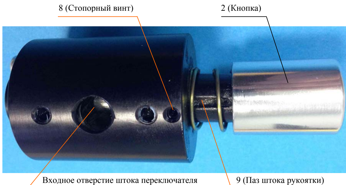
Рис. 7. Механизм фиксации рукоятки пульта ПН-2.1 в сборе
