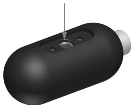
Рис. 5. Смазка рукоятки переключателя пульта ПН-2.1.
