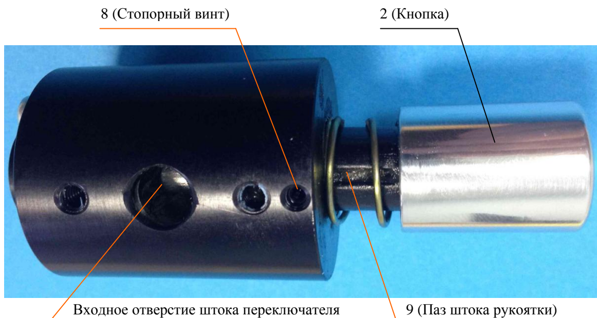
Рис. 7. Механизм фиксации рукоятки пульта ПН-2.1 в сборе
